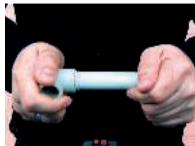
Zgrzewanie rury Stabi FAST
